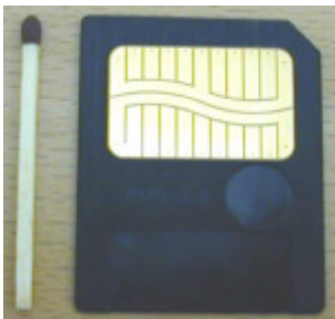
Bild 2.2 Ett minneskort av Smartmedia-typ tillsammans med en tändsticka för storleksjämförelse.
